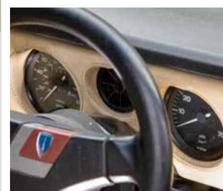
Le bloc compteur et compte-tours est installé devant le conducteur, mais l'implantation du volant gêne la lisibilité.
