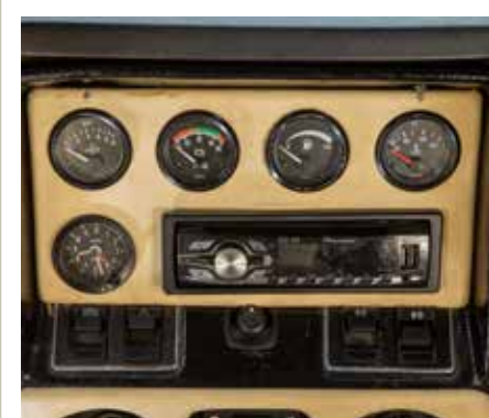
Le bloc d'instrumentation supplémentaire trône au sommet de la console centrale. Les aiguilles sont prises de spasmes quand le clignotant est actionné!
